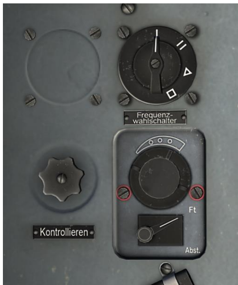
Рис 32: Переключатель частот, точная настройка приемника и регулятор громкости радиостанции FuG 16Z
