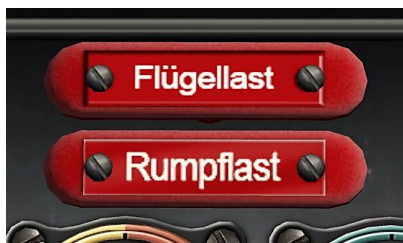
Рис 60: Рукоятка сброса подфюзеляжных и подкрыльевых подвесок
