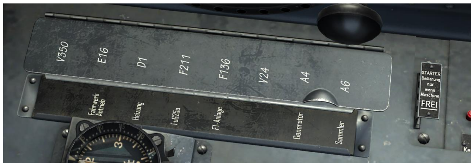
Рис 83: Крышка блоков переключателей закрыта
