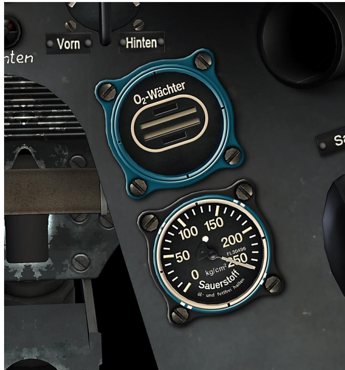
Рис 29: Индикатор подачи кислорода и кислородный манометр
