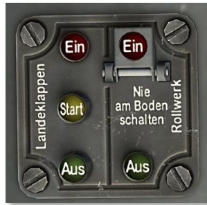
Рис 79: Пульт управление шасси и закрылками
