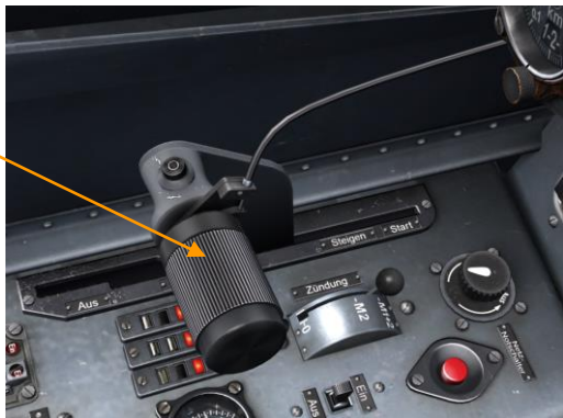
Рис 43: Рычаг управления двигателем с поворотной рукояткой и тросиком
