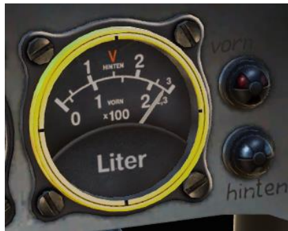
Рис 65: Топливомер и лампы аварийного остатка топлива
