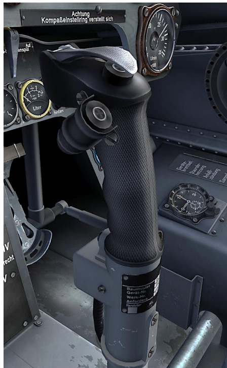
Рис 35: Ручка управления с триггером и кнопкой сброса бомб
