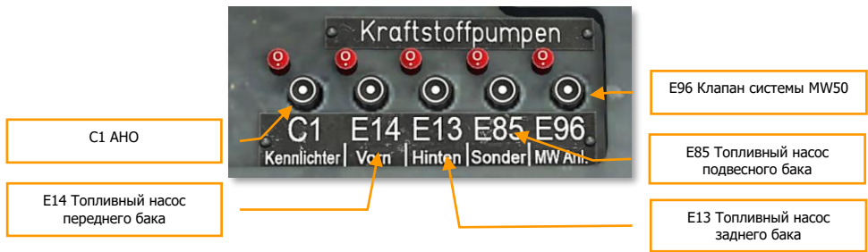
Рис 85: Переключатели дополнительной панели
