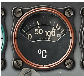
Рис 63: Индикатор температуры масла
