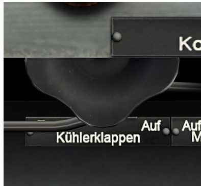
Рис 56: Кран ручного управления створками радиатора
