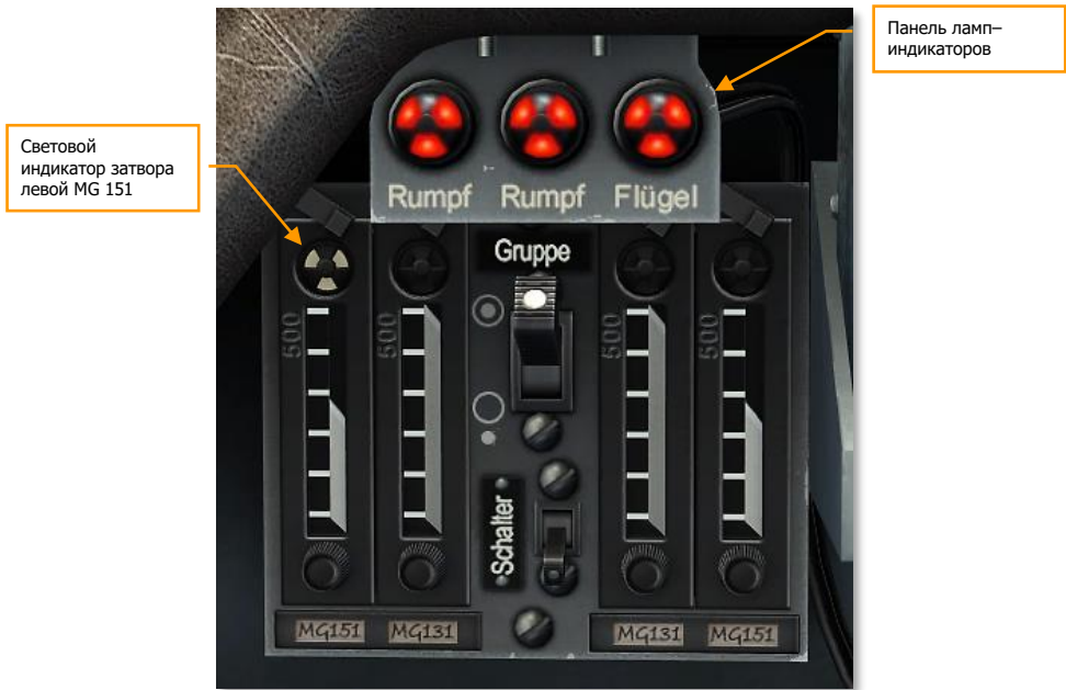
Рис 47: SZKK 4 с 4 счетчиками боеприпасов
