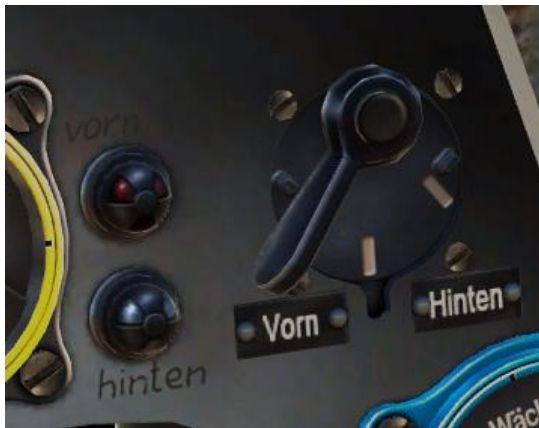
Рис 22: Лампы аварийного остатка топлива и переключатель топливомера
