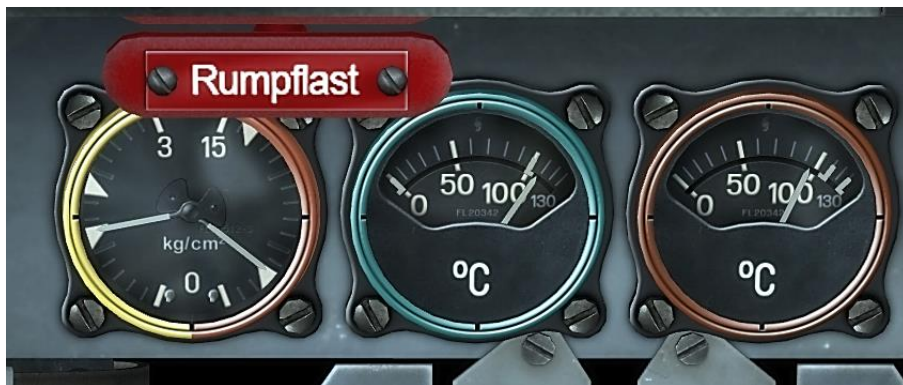
Рис 25: Топливо-масляный манометр, индикатор температуры охлаждающей жидкости и индикатор температуры масла
