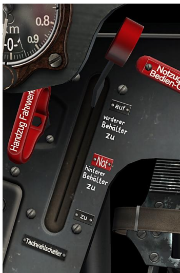
Рис 58: Рычаг селектора топливных баков
