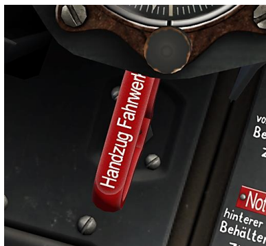
Рис 57: Рыкоятка аварийного выпуска шасси
